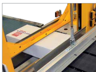
Batentes para o posicionamento correcto de embalagens/maços soltos
