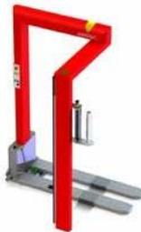
O modelo PL trata-se de um equipamento a ser instalado em uma paleteira elétrica ou em uma empilhadeira. Móvel, eficiente, com ótima qualidade de envolvimento. Compacta com um design inovador. O modelo PLB é projetado para utilizar uma fonte de alimentação própria com baterias ou utilizar alimentação externa, vinda das baterias de uma paleteira elétrica. Sendo assim o equipamento pode ser facilmente movido próximo à carga a ser envolvida.
