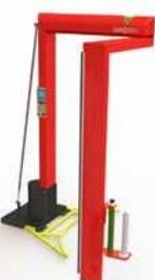
Modelo ST: Envolvedora com base fixa no solo. Esse modelo fixo permanentemente ao solo está entre os modelos que são oferecidos, geralmente para economia de espaço. O modelo STB é um equipamento móvel que não requer fixação ao solo. O eficiente e robusto equipamento garante o perfeito resultado de envolvimento com a otimização de consumo de filme stretch.
